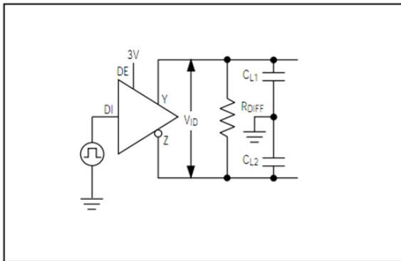
**图 3 驱动器时序测试电路**
