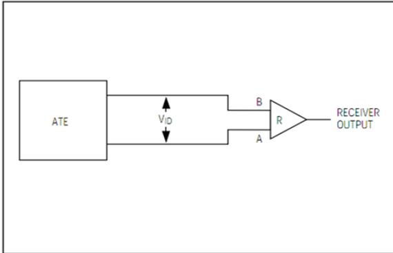
**图 7 接收器传播延时测试电路**
