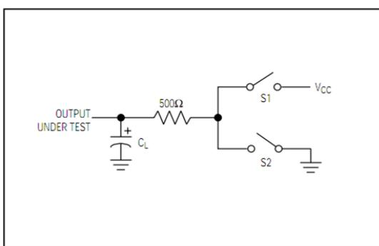
**图 5 驱动器使能/禁能时序测试电路**
