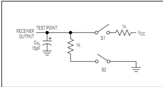
**图 9 接收器使能/禁能时序测试电路**
